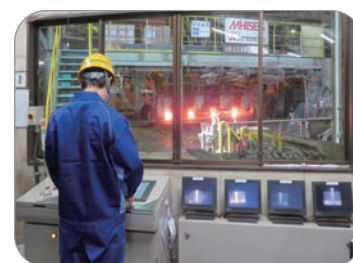
連続鑄造操作室
